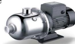
Материал проточной части нержавеющая сталь AISI 304, максимальная температура перекачиваемой жидкости до +85°C. Максимальная высота всасывания - 8 метров.
